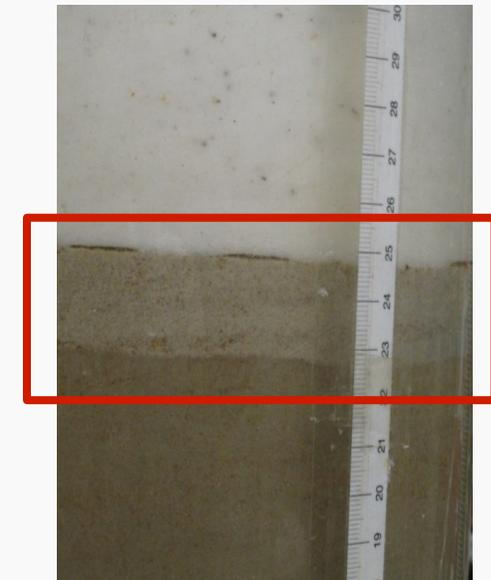
Herabsetzung des Wassergehaltes im Abbaubereich durch Schaumpenetration an der Ortsbrust
